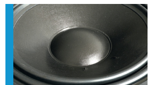
Gummisicke für große Auslenkungen.
