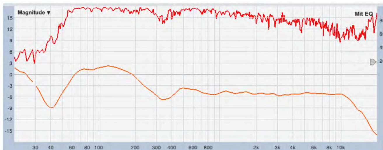
Durchschnittsfrequenzgang 10 - 60 Meter nach Optimierung - nur Top's
