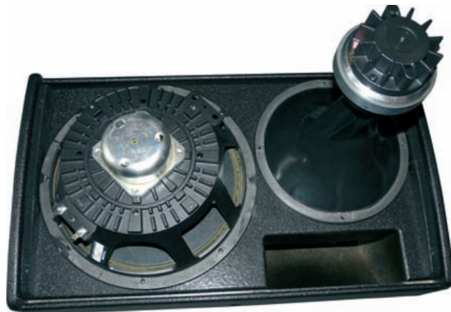
Foto 3: Bestückung der Seeburg A-6 dp mit Ciare-Neodymchassis und Oberton-Hochtontreiber
