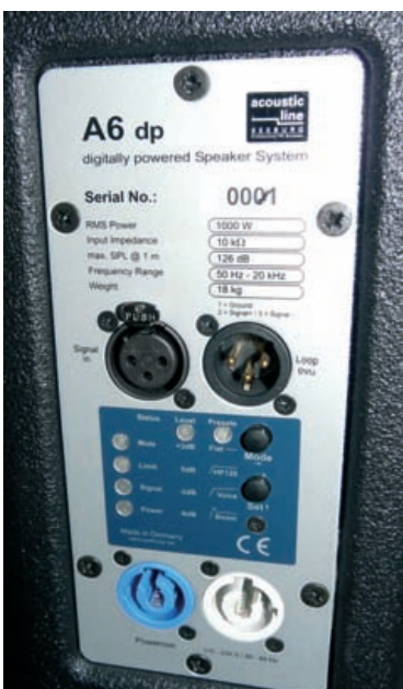
Foto 2: Anschlussfeld mit DSP-Bedieneinheit und Serien-Nr. 0001
