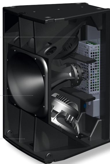
Die Schwingspulen der Treiber liegen vertikal in einer Reihe übereinander, um die zeitgleiche Abstrahlung ohne Phasenversatz auch mit passiver Frequenzweiche zu ermöglichen.
