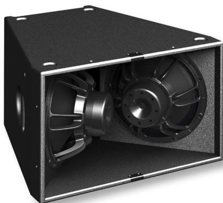
Das PS 1 EX Erweiterungsmodul verdoppelt die Leistungsfähigkeit des PS 1 Systems im Bereich von 80 bis 300 Hz (6 dB mehr Schalldruckpegel). Damit steht für größere Veranstaltungen und Open Airs nochmals spürbar mehr Punch und Dynamik zur Verfügung. Die beiden 12-Zoll Chassis können dabei über den selben Verstärkerkanal angetrieben werden wie der Low-Mid-Weg des PS 1, es wird lediglich ein angepasstes Preset benötigt, welches die dazugewonnene Empfindlichkeit berücksichtigt.
