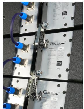
Einfache Montage mit Ball Lock Pins.
