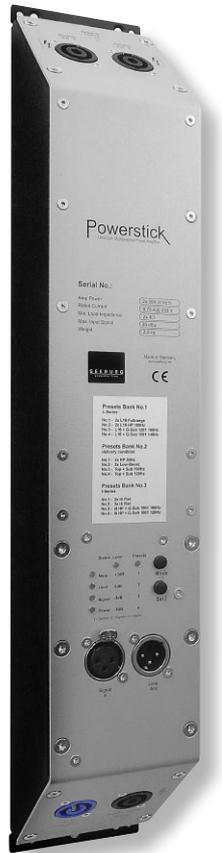
Der Powerstick ist ein ultra schlanker und besonders leichter Verstärker mit 2 x 500 Watt Leistung und integriertem DSP Controller. Er ist für den Einbau in die Ständersäulen (Monopods) der L-Serie konzipiert und lässt sich auch direkt rückseits an L-Serie Linienstrahler andocken. Aufgrund seiner Bauform und den verschiedenen Montagemöglichkeiten kann der Powerstick auch leicht als Einzelgerät in Trusskonstruktionen oder Messestände integriert werden.
