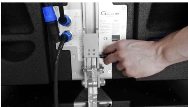
Der Winkel der weiteren Galeo T Einheiten wird vorgewählt, indem der Anschlag-Pin der darüber liegenden Galeo T Einheit in das Loch mit dem gewünschten Splaywinkel gesteckt wird. Dieser Vorgang wird nun bei allen Galeo T Einheiten durchgeführt.
