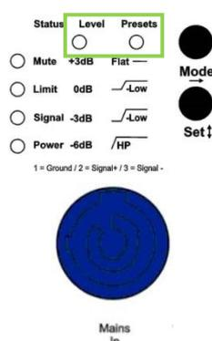
Die abrufbaren Lautsprecher-Presets können im DSP Controller auf bis zu 3 Bänke programmiert sein. Die Umschaltung der Bänke erfolgt durch Drücken und Halten der Mode-Taste während des Einschaltvorgangs.
