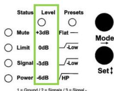
Durch einmaliges Drücken der Mode-Taste gelangen Sie in den Levelmodus, der Lautstärkeanpassungen in 3 dB Schritten erlaubt. Es stehen vier verschiedene Werte +3 dB, 0 dB (Standard), -3 dB und -6 dB zur Verfügung. Die Einstellung erfolgt durch den Taster „Set“. Die darüber befindliche grüne LED gibt Auskunft darüber, in welchem Modus Sie sich befinden, wobei die vier senkrecht angeordneten LED's (nun grün leuchtend) den jeweils eingestellten Wert angeben.
