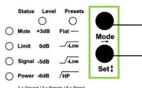
Das gleichzeitige Drücken der Set- und Mode-Taste von mehr als drei Sekunden bewirkt eine Sperrung der Bedienfunktionen. Die Aufhebung dieser Sperrung erfolgt durch wiederholtes Drücken der beiden Tasten in gleicher Weise.
