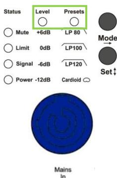
Die abrufbaren Lautsprecher-Presets können im DSP Controller auf bis zu 3 Bänke programmiert sein. Die Umschaltung der Bänke erfolgt durch Drücken und Halten der Mode-Taste während des Einschaltvorgangs.
