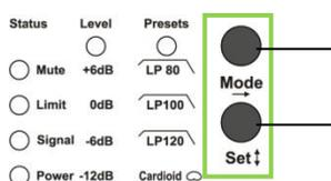
Das gleichzeitige Drücken der Set- und Mode-Taste von mehr als drei Sekunden bewirkt eine Sperrung der Bedienfunktionen. Die Aufhebung dieser Sperrung erfolgt durch wiederholtes Drücken der beiden Tasten in gleicher Weise.
